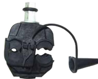
A linha IPC possui ampla faixa de bitolas para aplicação. Sistema de aperto com porca break-away (fusível). Fechamento com garantia de estanqueidade. Produzidos com matéria-prima termoplástica, com protetor UV. Capuz isolante fornecido para proteção da extremidade do condutor de derivação. Componentes metálicos com proteção anti corrosão. Conceito piercing de perfuração do isolante.
