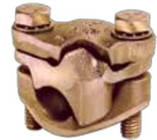
Grampo multi-direcional, com base e tampa em bronze de alta resistência, mecânica e à corrosão. Separador em cobre de alta condutibilidade elétrica. Acessórios de fixação (parafuso e arruela), fabricados em aço zincado a fogo. Instalação rápida e fácil. Para emendas paralelas, derivações em "T" ou em cruz. Dotado de arruela de neoprene para evitar queda de parafuso durante a instalação. Para bitolas diferentes consultar a BURNDY®.
