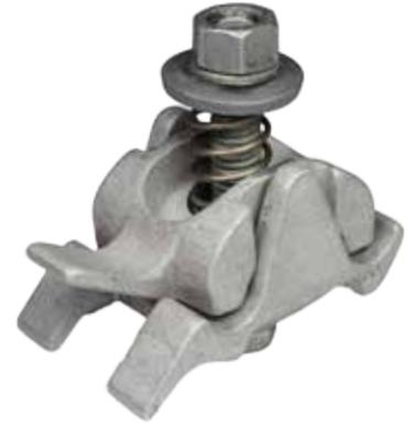
O conector Burndy Fastap™, com Lineman Assist™ é uma solução nova e pioneira para um problema antigo, utiliza sistema de mola para facilidade na instalação, permitindo uma conexão segura e confiável. O Fastap™ adiciona três recursos exclusivos para o encaixe padrão do grampo paralelo: mola Lineman Assist™, presilha bico de pato, e a capacidade de entrada lateral do condutor.
