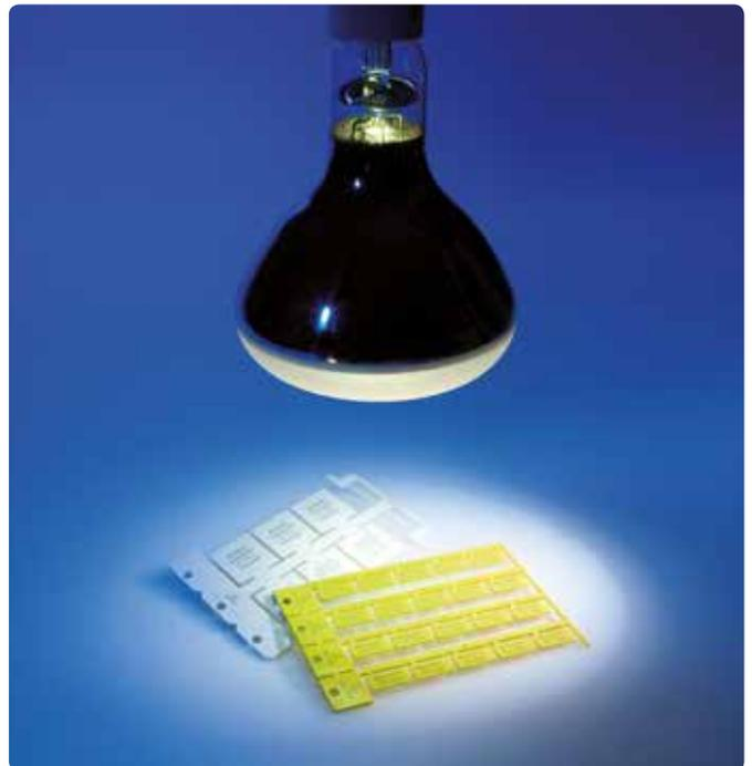
Ensayo de resistencia a radiación UV
